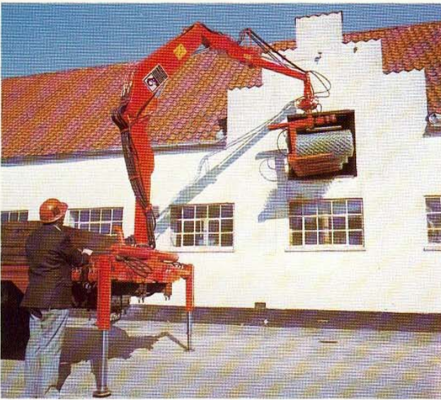
Die Hubleistung des HIAB 550 ist beachtlich! Bei der größten Ausladung von 5 m hebt der Kran bis zu 1.100
