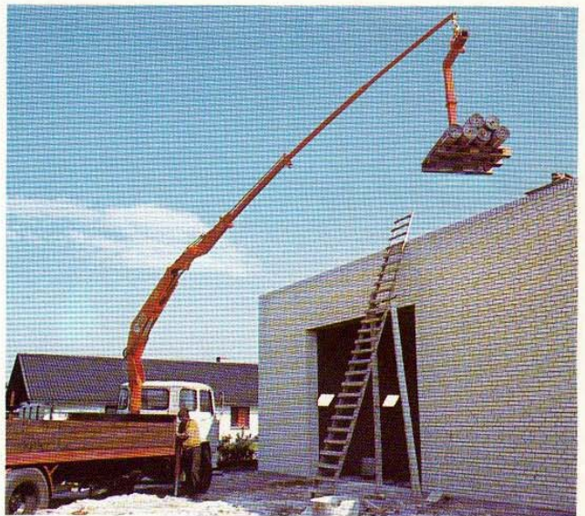
Bei Verwendung von Armverlängerungen erhält der HIAB 550 eine Reichweite bis zu 9 m.
